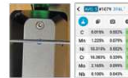
Рис. 4. Анализ Углерода в проволоке 1/8 дюйма, сталь 316L с SciAps Z-902
