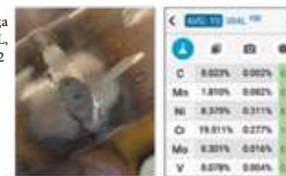
Рис. 3. Анализ Углерода ниппеля трубы диам. 1” s/160 A106 для обслуживания установки HF алкилирования с SciAps Z-902
