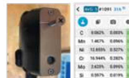
Рис. 2. Анализ Углерода винта машины диаметром ¼”, сталь 316H с SciAps Z-902
